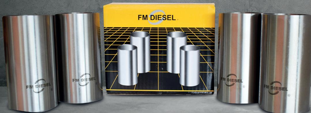
Las camisas son revestimientos con forma cilíndrica con capacidad para retener una fina película de aceite sobre la superficie de su pared interna que, al introducirse en los cilindros del bloque de motor, lo protegen del desgaste provocado por el deslizamiento de los pistones.
